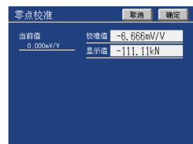
主画面→设定→初始设定→Y轴设定→零点校准
